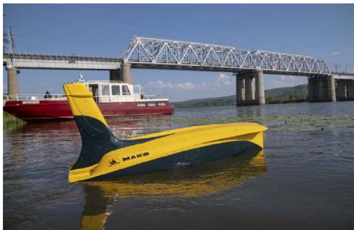
АППАРАТ «ГЛАЙДЕРОН» ДЛЯ СКАНИРОВАНИЯ ДНА ВОДОЕМОВ И ПОДВОДНОГО ОБСЛЕДОВАНИЯ КОНСТРУКЦИЙ
