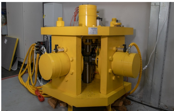
УНИКАЛЬНАЯ ИСПЫТАТЕЛЬНАЯ УСТАНОВКА ДЛЯ ИМИТАЦИИ ПЛАСТОВОГО ДАВЛЕНИЯ
